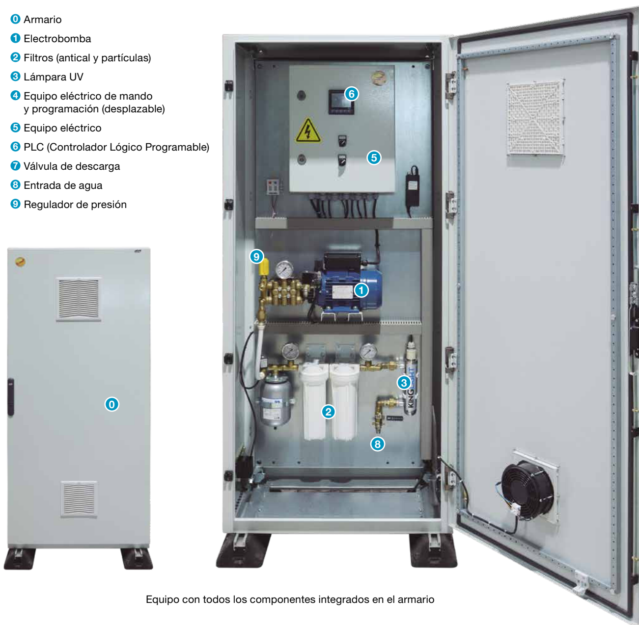
Equipo con armario para bomba y filtración, cuadro eléctrico desplazable y PLC externo
